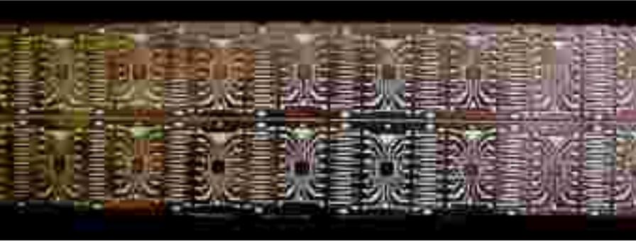
Los leadframes, que son comunes en todos los equipos electrónicos transistorizados, distribuyen las señales eléctricas y la energía entre chips de circuitos integrados (IC) y circuitos externos; transfieren calor desde los chips a los disipadores de calor y mantienen chips dentro del material encapsulado. Las conexiones son hechas soldando un hilo entre el chip IC y el leadframe.
